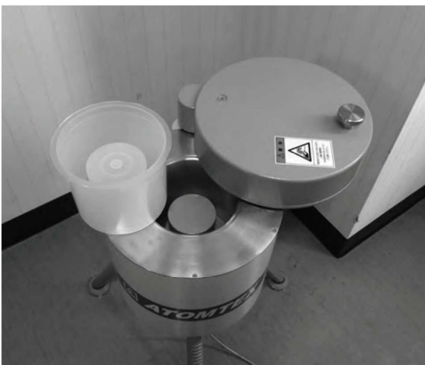
保健センターにあるATOMTEX社製食品測定器
